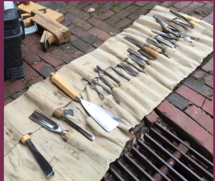
Abb. 33: Verschiedene Stech- und Hohlbeitel zur Holzbearbeitung
